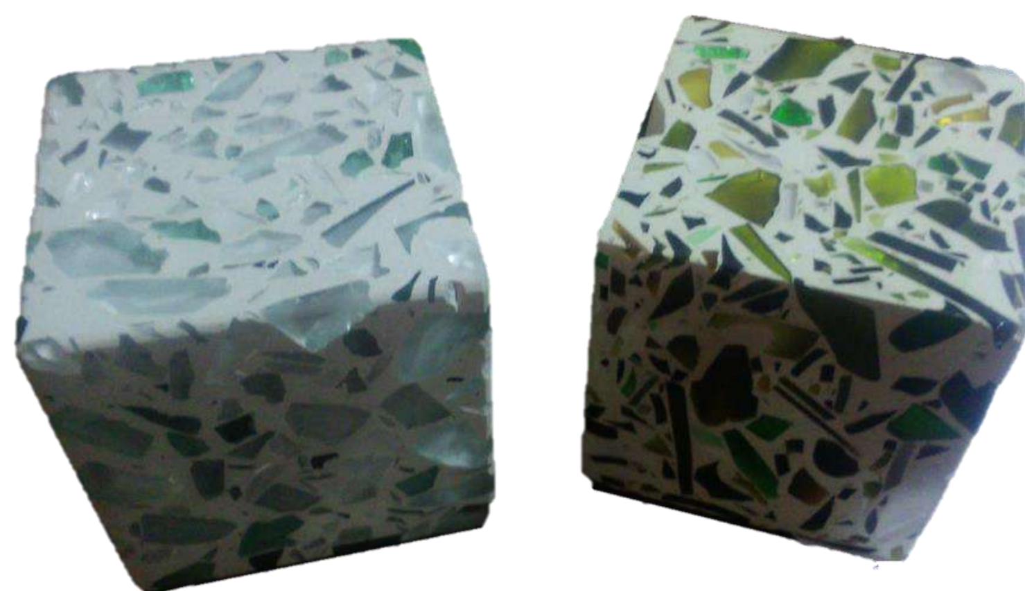
Figura 1: Concreto branco com resíduos de vidro temperado.
