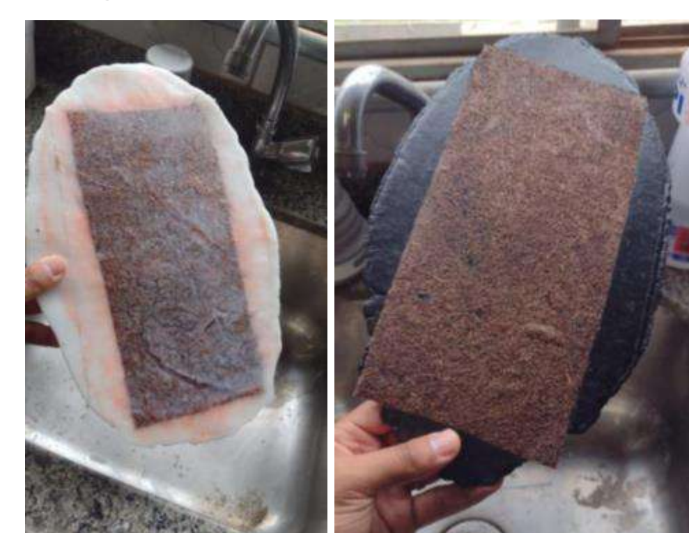
Figura 2: Modelagem sustentável com fibra de coco: aplicações para substituição da fibra de vidro: A-PP reciclado + Fibra de coco B-TPU reciclado + Fibra de coco
