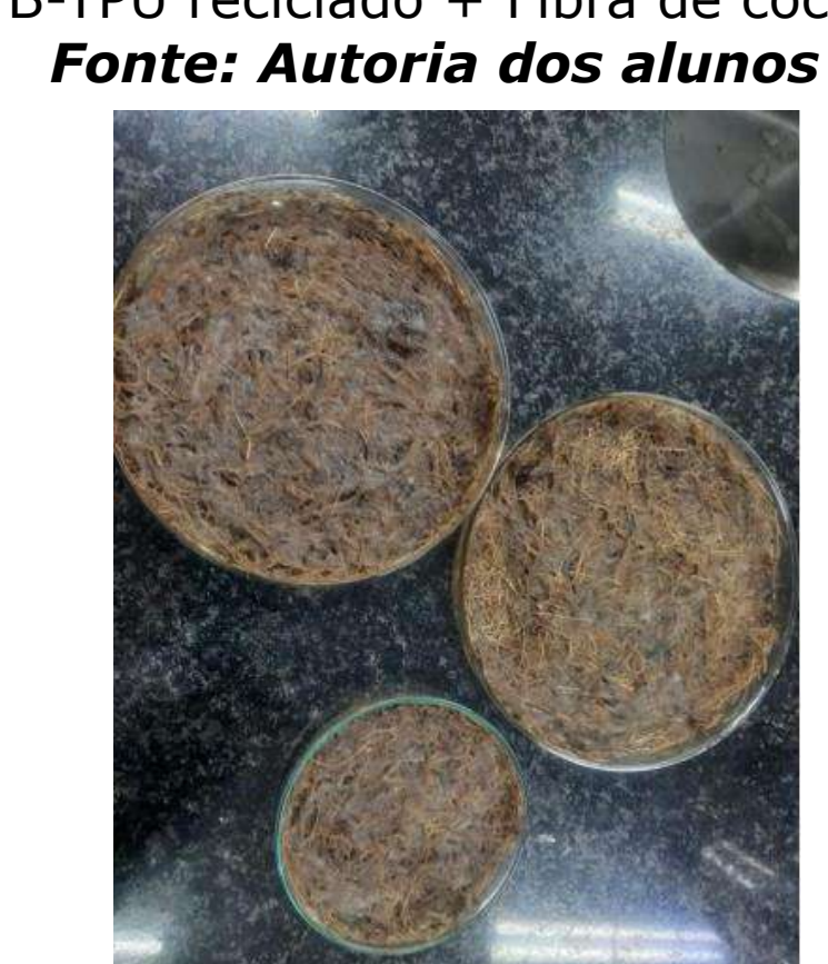
Figura 5: Compósito de amido de mandioca com Fibra de Coco e Fibra de Bananeira para utilização em Embalagens para o Setor Hortifruti Fonte: Autoria dos alunos
