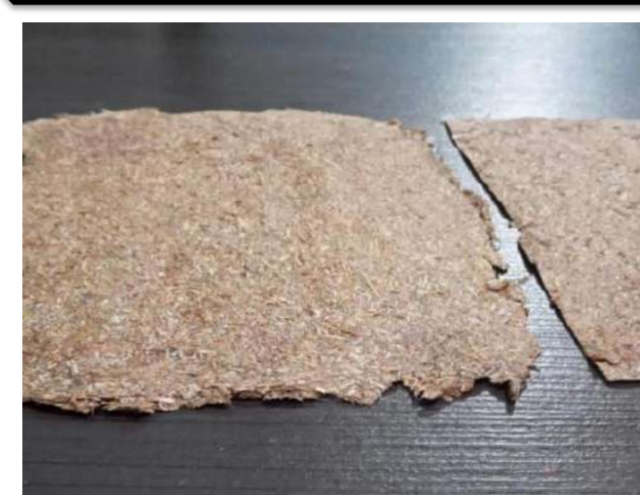
Figura 4: Desenvolvimento de máscara biodegradável a partir de amido e fibra de bananeira Fonte: Autoria dos alunos
